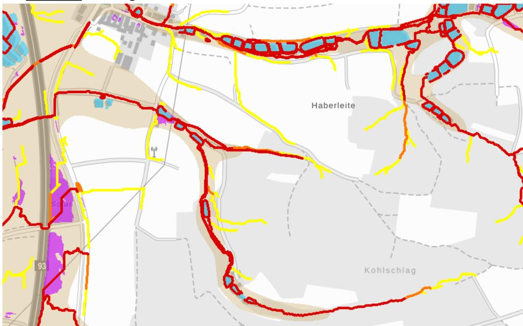
Ausschnitt HiOS-Karte (Potentielle Fließwege bei Starkregen: rot = starker Abfluss möglich, orange = erhöhter Abfluss möglich, gelb = mäßiger Abfluss möglich; hellbraun = wassersensibler Bereich; violett = Geländesenke / möglicher Aufstaubereich)
